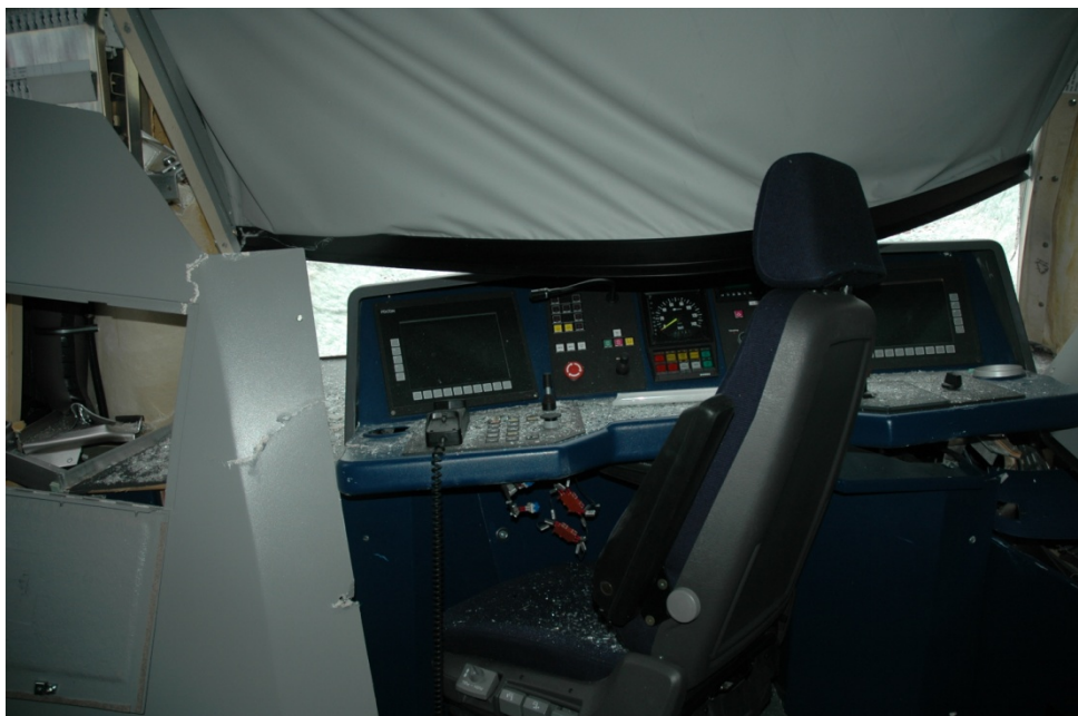
Bageste førerrum i tog 41236 (SA 8169), efter kollisionen
